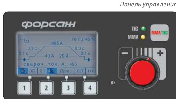
Аппарат можно использовать и для ручной электродуговой сварки постоянным током (**MMA DC**) и переменным током (**MMA AC**).
