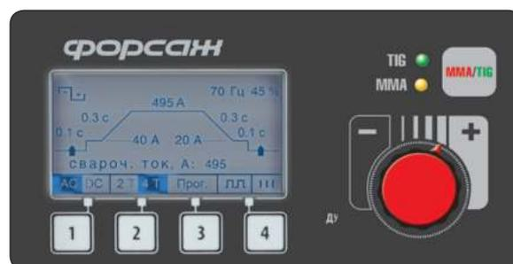
Аппарат можно использовать и для ручной электродуговой сварки постоянным током (MMA DC) и переменным током (MMA AC).
