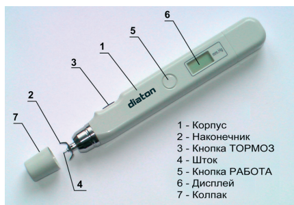
Рисунок 2 Транспальпебральный склеральный тонометр diaton
